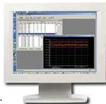
Il Software acquisisce ed archivia queste misure per poterle presentare sia in forma tabellare che in forma grafica. Il sistema permette di tenere sotto osservazione, le variazioni ed il trend delle misure di tensione ed impedenza. Ciò facilita le decisioni per la manutenzione preventiva della batteria.
